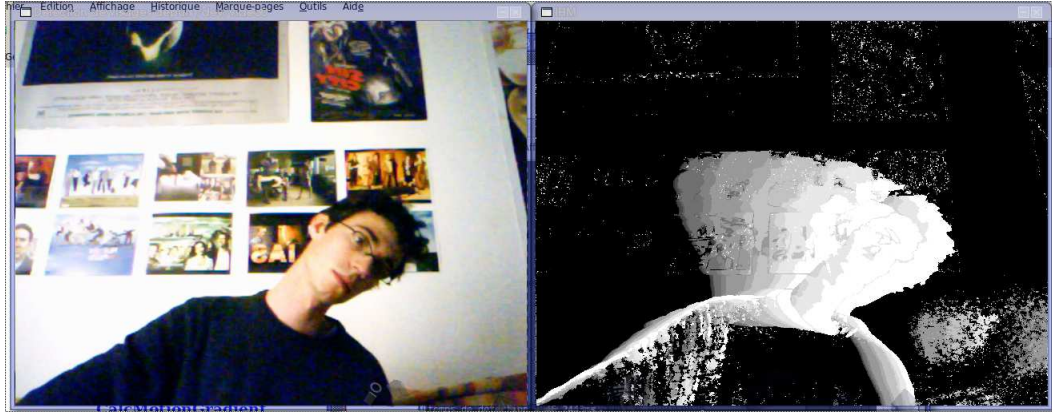
FIG. 9.2 – A gauche, la fenêtre affichant les images capturées. A droite, celle affichant l'historique de mouvement. Un mouvement de gauche à droite a été effectué et est visible sur l'historique de mouvement. Les zones les plus ternes correspondent aux silhouettes de mouvement les plus anciennes dans le temps, les plus lumineuses aux plus récentes.
